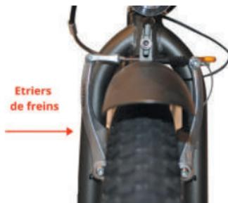
**MICRO RÉGLAGE PÉRIODIQUE D'AJUSTEMENT** : pour les freins AVANT et ARRIÈRE, serrer complètement l'érou sur la poignée de frein, ce réglage vous permettra de compenser plus tard le relâchement naturel du câble de frein.
