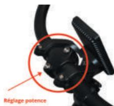
⚠ Faites de même avec la seconde vis pour le réglage de l'inclinaison de votre guidon. Après réglage, resserrer énergiquement les vis, couple de serrage maxi : 6 Nm.
