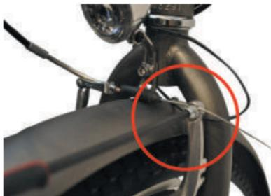
Les patins sont bien réglés lorsqu'ils se trouvent à distance égale de la jante. Le réglage final est à faire en serrant les vis montées sur les supports de patins avec la clé Allen (distance d'environ 0.1 à 0.5 mm de la jante).
